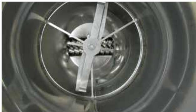
Figura 2 en esta sección. Leyenda, Agitación del alimentador interno
